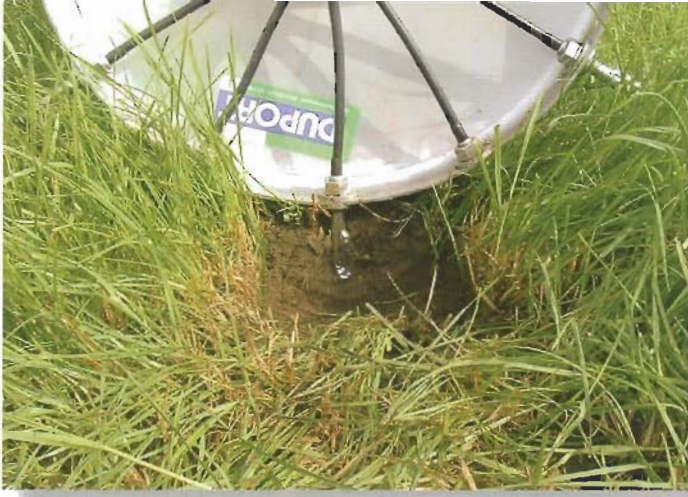
De prikpen brengt de vloeibare meststof gelijk op ongeveer vijf tot acht centimeter diep in de bodem.
